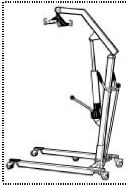
شکل ۳-۹ مکانیزم دستی ( پمپ کنترل هیدرولیک ) (۴)
